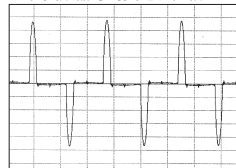
變頻器(輸入側)的電流波形
