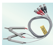
4端子探棒9140-10 線長1m，DC~200kHz，50Ω，可測量端子直徑：0.3~5mm
