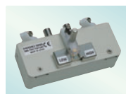
SMD測試治具9699 直接連接型，下面有電極的SMD用，DC~120MHz，被測物尺寸：寬1.0~4.0mm，高度1.5mm以下
