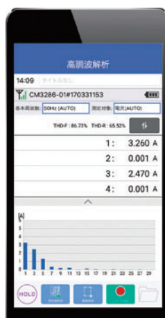
最多30次的諧波分析 確認電源品質
