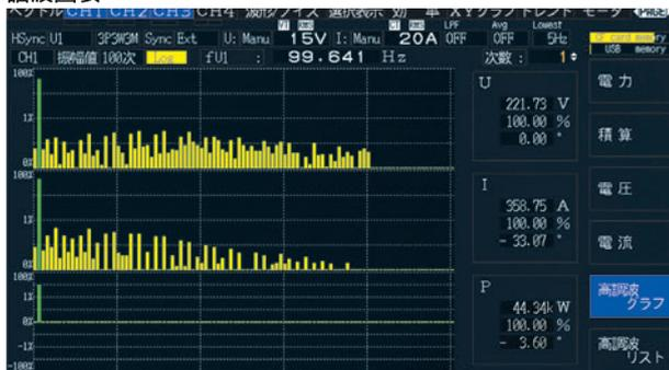
電壓 / 電流 / 功率可顯示最高 100 次的諧波柱狀圖。所選擇的次數的數值數據也能同時確認
