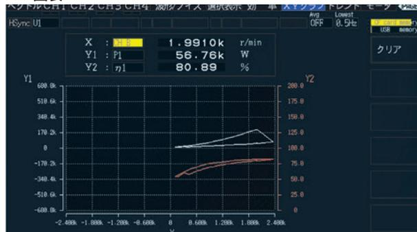
用於評估變頻器的特性或馬達的扭矩圖的製作。選擇任意項目，可顯示 X-Y 曲線圖
