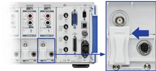
高精度感測器用端子：將滑蓋往左移。
