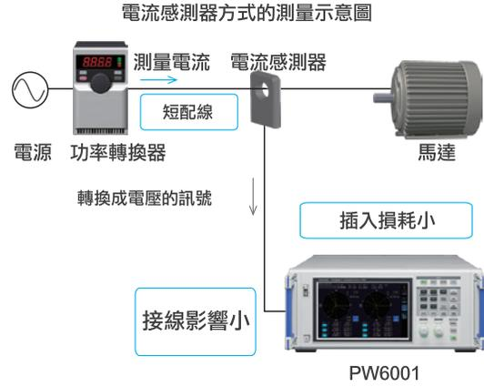
與直接接線方式相比，可在接近功率轉換器實際工作環境的狀態下進行測量。
